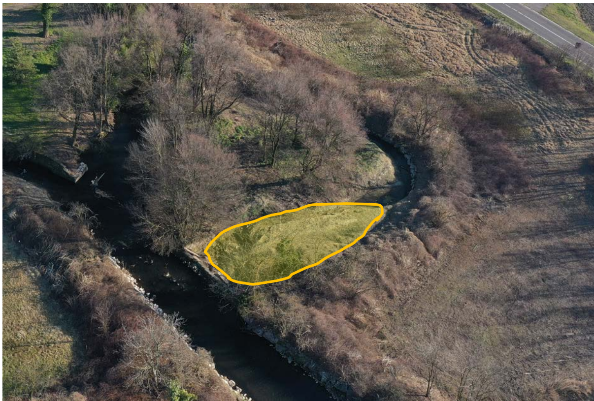
Figura 9: particolare del ramo originale quasi completamente interrito. In evidenza il deposito all'interno del ramo 1 di monte
